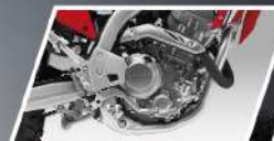
250 CC ENGINE เครื่องยนต์ 250 ซีซี DOHC ระบายความร้อนด้วยน้ำ ระบบหัวฉีด PGM-FI
